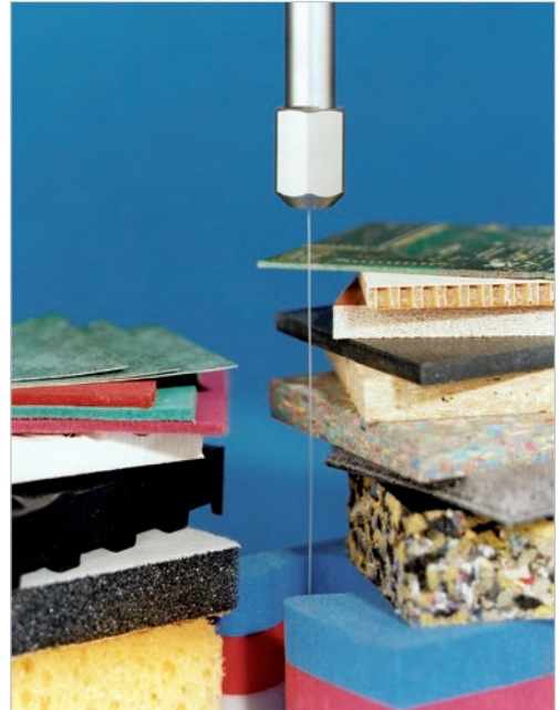
Verschiedene Materialien, geschnitten mit dem reinen Wasserstrahl.
