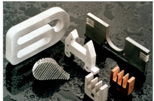
Technische Bauteile, geschnitten mit dem Wasserabstrahlstrahl.
